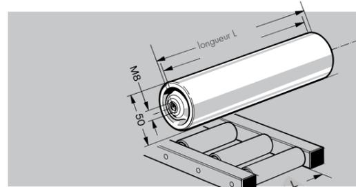
**Rouleaux de convoyeurs:** friction très réduite - idéal pour du convoyage par gravité.
