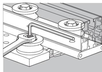
**Montage:** monter d'abord les galets à axe excentrique - visser cet axe à fond en tenant l'écrou avec une clé n° 13. Par la suite dévisser l'axe d'environ un demi-tour en position "jeu maxi". Serrer très légèrement l'écrou. Monter et serrer les galets à axe cylindrique.
