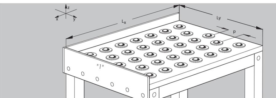
**Table à billes:** pour le transport de panneaux, caisses, cartons rigides et d'autres objets à surface plane. Panneau en PE 20 mm avec billes à collerette au pas de 100 ou de 50 mm en quinconce. Avec et sans bords antichute "1". Pour toute étude nous consulter.
