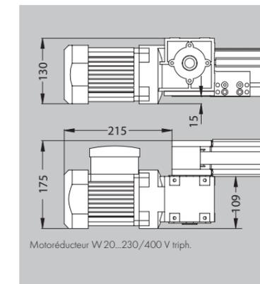
**Module linéaire NAPCC:** guidage linéaire sans jeu sur galets en polyester NAP57 (p. 58) avec entraînement par courroie crantée AT 5x25 incorporée dans un profilé NORCAN 45x90 N 0166.
