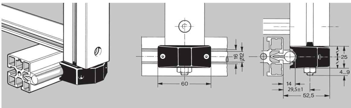
Possibilités de montage direct des cassettes K 12 N 1920 et N 1930 sur des platines et profilés NORCAN. Pour le montage avec entretoise voir tableaux ci-dessous.
