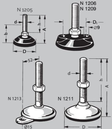
**Pieds réglables:** pieds en polyamide noir avec pastille anti-vibration et vis orientable en acier (N1211 et N1213 assiette et tige en inox avec pastille anti-vibration). Types et dimensions voir tableau ci-dessous.
