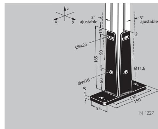
**Pied à sceller pour profilé demi fermé - N 1227:** avec 4 vis CHc M8x16, 4 rondelles M8 et 4 écrous M8 SC. Pour la fixation ajustable de montants de structure en profilé NORCAN 45x45 demi fermé.
