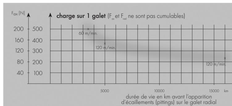
**Durée de vie et charges limites:** le tableau ci-contre représente les résultats d'une série d'essais effectués sans lubrification sur un banc de test entièrement caréné.
