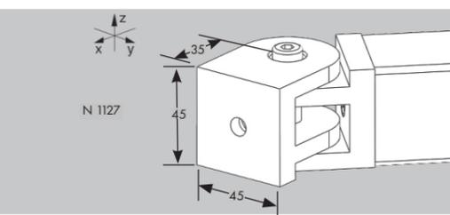
**Articulation 45 x 45 dynamique - N 1127** avec 2 vis M8 x 20 et 2 écrous M8 SC pour la fixation sur la face de coupe ou la face latérale des profilés NORCAN. Pour la réalisation des liaisons dynamiques de -90° à +90°.
