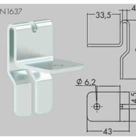
**Appui de panneau sur grillage 40x40 Ø4 - N 1637 :** Permet la fixation d'un panneau à l'horizontale sur un grillage maille 40x40x4mm.
