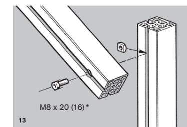
\*) Fig. 11, 12, 13: En cas d'utilisation d'une vis sans plaque d'appui et d'un écrou dans la rainure d'un profilé lourd prévoir une vis M8x16 - N 3133.
