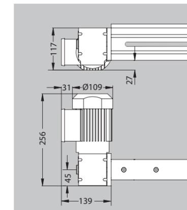
**Modules linéaires NAPV et K12V:** guidages linéaires sur galets (NAPV voir NAP57 p. 58, K12V voir K12 p. 60) avec entraînement par vis trapézoïdale Tr 16x4 et écrou en matière synthétique incorporés dans un profilé NORCAN 45x90 N 0166.
