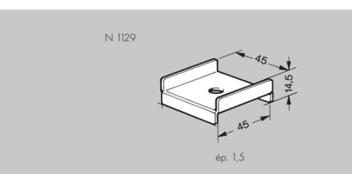
**Plaque d'antirotation - N 1129:** permet d'immobiliser en rotation sous 90° des profilés ou accessoires d'une largeur de 45 mm. Couple maxi  $M_r = 80$  Nm.
