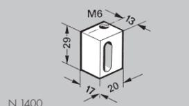
**Bloc de fixation - N 1400 :** avec vis M8 x 30 et écrou M8 SC. Pour la fixation de plaques et éléments divers, hauteur réglable de 0 à 16 mm. Livré avec une rondelle imperdable M6
