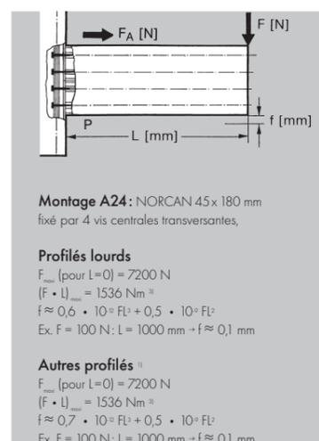
**Conditions d'essai:** profilés: matière AFNOR 6060 (Al Mg Si 0,5), charge à la rupture 250 Nmm<sup>2</sup>, limite élastique > 200 Nmm<sup>2</sup>, anodisé 15 µm.
