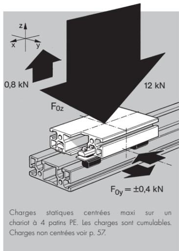
**Guidage linéaire sur patins PE** (p. 57) : guidage économique et robuste particulièrement résistant aux chocs dans la direction - z (3kN), idéal pour l'entraînement par vis trapézoïdale.
