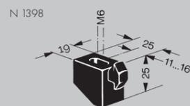
**Bloc de fixation 1/4 de tour par vis - N 1398 :** pour la fixation de panneaux de 1 à 5 mm sur la face rainurée des profilés N 0163, N 0164, N 0195, N 0264 et de panneaux de 1 à 19 mm sur tout autre profilé NORCAN rainuré. Le bloc est équipé d'un écrou prisonnier M6 et livré avec une rondelle imperdable M6
