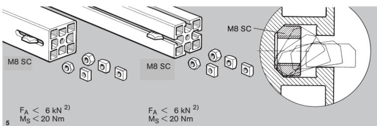
Fig. 5: les écrous M8 standardisés hexagonaux et carrés (clé de 13 mm) peuvent être glissés dans la rainure et y sont immobilisés en rotation. Les écrous M8 SC, DSC, LSC, RSC, RLSC peuvent être basculés dans la rainure.
