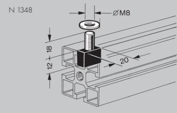
**Patin sur tige M8 - N 1348** avec rondelle en polyamide pour le guidage de portes coulissantes ou pliantes dans la rainure des profilés NORCAN.
