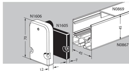
**Profilé en U 45x45 - N 0867:** pour boîtes à galets. Matière: alu anodisé nature. I<sub>y</sub> = 5 · 10<sup>4</sup> mm<sup>4</sup>
