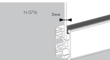
**Ruban souple de montage - N 0716 :** pour l'immobilisation de plaques et vitres de 5 mm dans la rainure.
