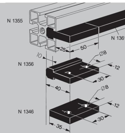
**Profils de guidages** en polyéthylène de haute masse moléculaire, noir. Pour la réalisation de glissières utilisant la rainure des profilés aluminium NORCAN.
