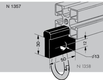
**Profil de guidage - N 1357**: Patin coulissant pour suspendre divers objets, par exemple des outils électriques ou pneumatiques de postes de travail. Charge maxi 40 kg. Matière: polyéthylène noir.
