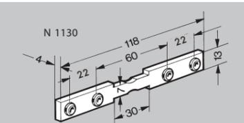
**Barrette de liaison d'angle - N 1130** avec 4 vis sans tête pour l'aboutage et le raccordement en biais sous faible charge, essentiellement en cartérisation.
