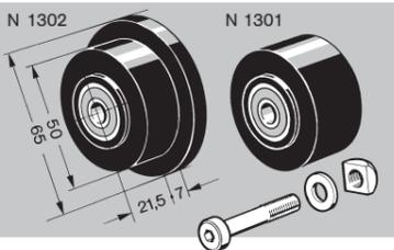
**Galet à roulement épaulé - N 1302** avec vis M8 x 43, rondelle et écrou M8 SC. Galet en PA 6.6 sur 2 roulements et fixation par vis M8 centrale.
