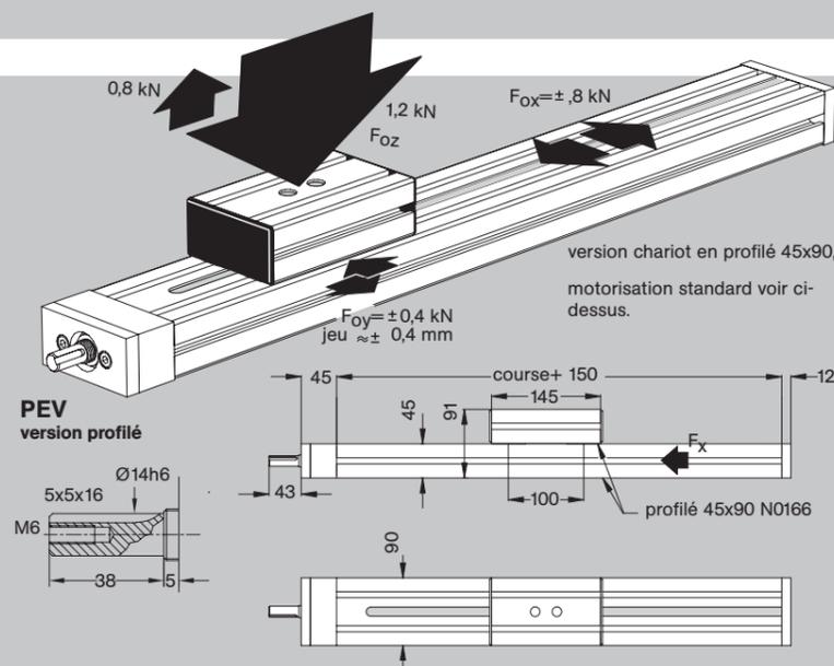
Charges axiales sur la vis d'entraînement - les valeurs comportent un facteur de sécurité de 3 contre le flambage de la vis, Tr 16x4.
