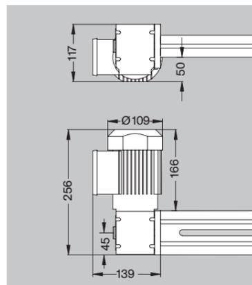
**Module linéaire PEV:** guidage linéaire sur patins PE N 1363 (p. 57) avec entraînement par vis trapézoïdale Tr 16x4 et écrou en matière synthétique.
