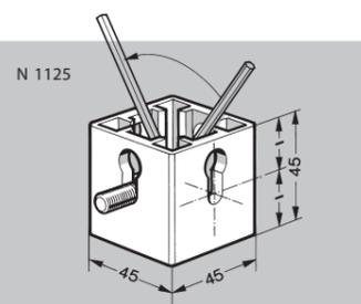
**Bloc 5 directions - N 1125** avec 5 vis M8x20 et 1 embout 45x45 N 1705 pour des montages en croix à charge de flexion modérée.
