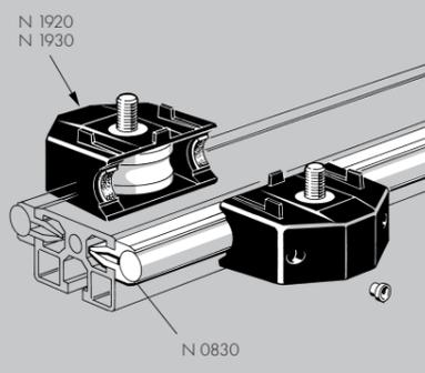
Les guidages linéaires K 12 sont constitués de profilés aluminium NORCAN munis d'arbres en acier traité et de galets à roulement individuellement protégés et lubrifiés par des cassettes en polyamide renforcé. Les graisseurs permettent de recharger en **huile** (ne pas utiliser de la graisse!) les feutres de lubrification.
