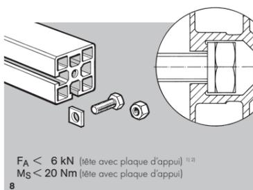
Fig. 8: les vis M8 standardisées (diamètres de tête 13 mm) peuvent être glissées dans la rainure, les vis à tête hexagonale et carrée y sont immobilisées en rotation.
