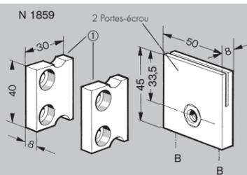
**Kit 2 pour démontage rapide des panneaux - N 1859:** avec visserie. Même application que N 1860, mais les pièces d'appui "1" sont immobilisées en rotation par 2 vis et peuvent donc être montées sans reposer sur une pièce adjacente comme N 1860.
