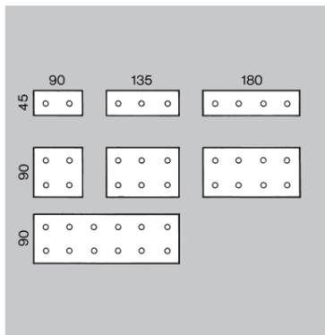
**Platines d'assemblage** avec vis M8 x 20 et écrous M8 SC
