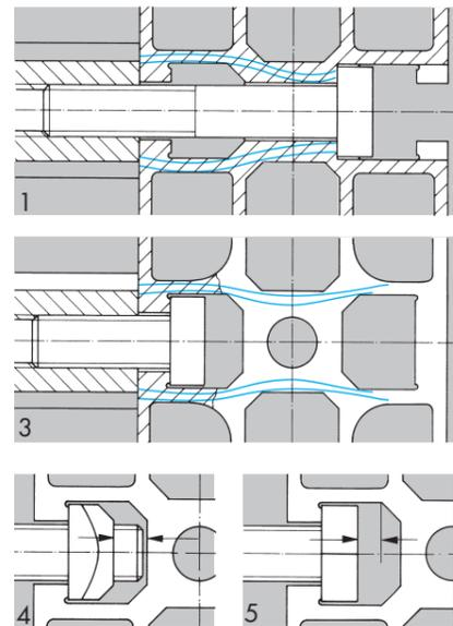
2. Les profilés NORCAN ont une rainure profonde permettant un jeu de montage axial important pour les têtes de vis et écrous (fig. 4 et 5).
