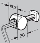
**Noix d'assemblage - N 1140** avec vis M8 x 30 et écrou M8 SC
