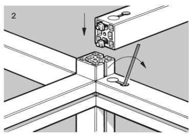
L'exemple montre une possibilité de montage avec vis M8 x 30 et écrou M8 SC.
