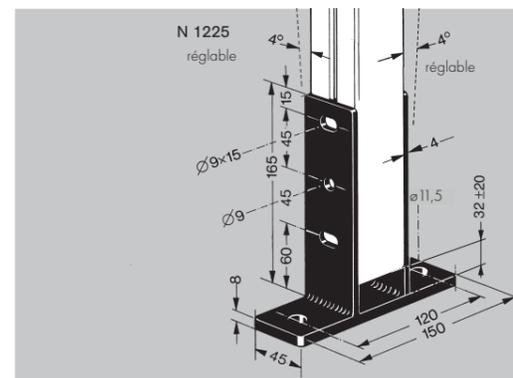
**Pied à sceller 45 x 45 - N 1225:** avec 6 vis CHc M8 x 20, 6 rondelles M8 et 6 écrous M8 SC. Pour la fixation ajustable de montants de structure en profilé NORCAN 45x45, 45x90 et 45x135 mm, dans les derniers cas prévoir éventuellement 2 pieds de scellement. Matière: acier finition époxy noir.
