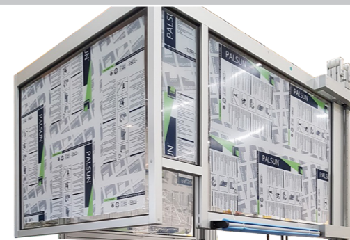
Cartérisation coulissante et équilibrée, équipée de rails à recirculation de billes
