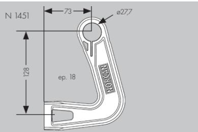
**Poignée pour tube Carenal ø27,7 - N 1451** avec visserie Pour la réalisation de poignée ergonomique sur les chariots de manutention
