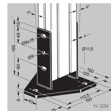
**Pied à sceller 45 embase 3 points - N 1224:** avec 6 vis CHc M8x20, 6 rondelles M8 et 6 écrous M8SC. Pour la fixation ajustable de montants de structure en profilés NORCAN épaisseur 45 mm.
