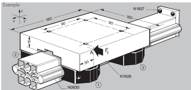
Sur le chariot ci-dessus une force de  $F_y = 500 \text{ N}$  s'exerce sur le point A.
