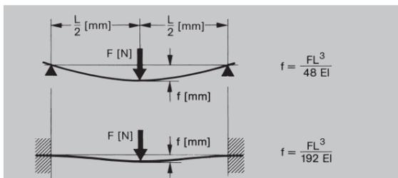
**Profilé entre deux appuis:** ce problème peut être considéré comme intermédiaire entre la flexion d'une poutre sur deux appuis et la flexion d'une poutre encadrée des deux côtés. Les montages type A31 (ci-dessous) se situent plutôt vers la première formule, les autres montages vers la deuxième.
