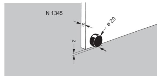
**Pastille PE pour portes coulissantes de 8 mm - N 1345:** autolubrifiant, pour réduire le coefficient de friction et la tendance au grippage des portes coulissantes de 8 mm. Dimensions des panneaux voir p. 48.
