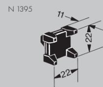
**Bloc fixe câble 1/4 tour - N 1395 :** pour la fixation par serre-câbles des conduits d'air comprimé, câbles électriques etc.
