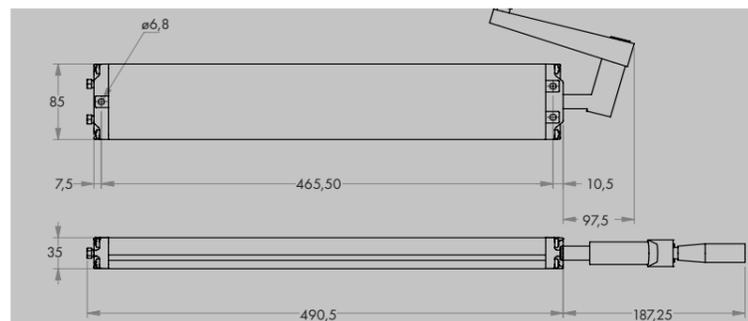
**Pompe hydraulique 4 sorties - N 1074 :** Pour l'alimentation de 3 à 4 vérins.
