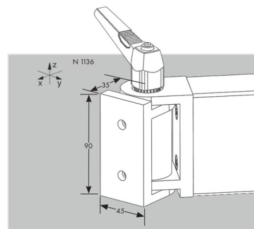
**Articulation 45 x 90 avec poignée de serrage - N 1136:** avec 2 vis M8 x 20 pour la fixation sur la face de coupe ou la face latérale des profilés NORCAN. Pour la réalisation de liaisons dynamiques de -90° à +90°.
