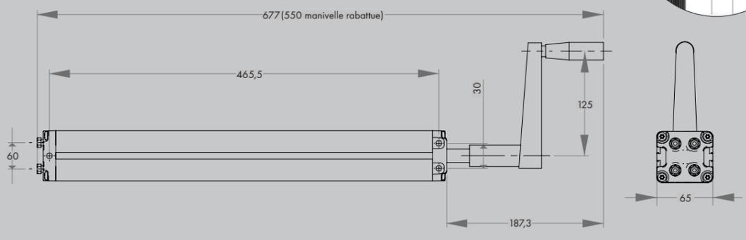
**Pompe hydraulique motorisée course 290mm :** Charge maximale pompe 3500N. Vitesse d'élévation : 15mm/s. Pompe pré-remplie d'huile. Alimentation 230V monophasé. Indice de protection IP30 (moteur et télécommande) et IP20 (boîtier de commande)
