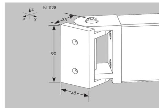
**Articulation 45 x 90 dynamique - N 1128:** avec 4 vis M8 x 20 et 4 écrous M8 SC pour la fixation sur la face de coupe ou la face latérale des profilés NORCAN. Pour la réalisation de liaisons dynamiques de -90° à +90°.
