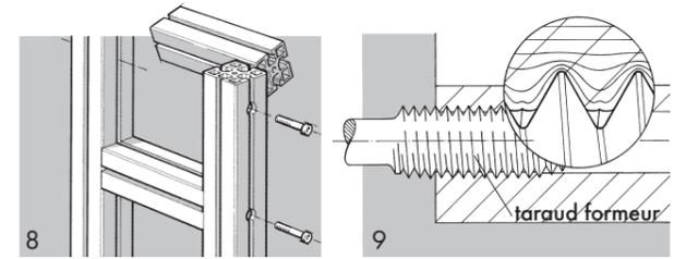
5. Les taraudages dans les profilés sont effectués avec un taraud formeur d'où une résistance mécanique accrue, ce procédé déforme les fibres au lieu de les couper et ne génère pas de copeaux. (fig. 9).
