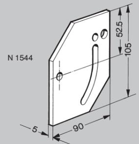
**Support pour repose-pied - N 1544** avec 3 vis CHc M8 x 20, 2 écrous M8 SC, 3 rondelles Ø8 et 1 doigt d'anti-rotation.
