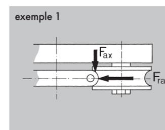
**Exemple 1:** un galet est chargé d'une charge axiale de  $F_{ax} = 60$  N et simultanément d'une charge radiale de  $F_{rad} = 100$  N à une vitesse de 120 m/min.
