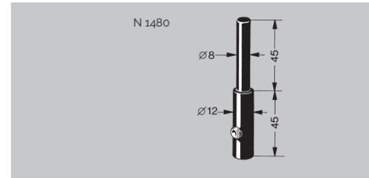
**Doigt de guidage - N 1480:** pour des cadres de portes et vitres coulissantes qui doivent être facilement déboîtées. Le doigt est rétractable après desserrage de la vis.
