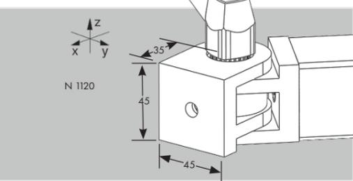
**Articulation 45 x 45 avec poignée de serrage - N 1120** avec 2 vis M8 x 20 pour la fixation sur la face de coupe ou la face latérale des profilés NORCAN. Pour la réalisation de liaisons de -90° à +90°.
