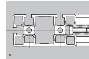
Fixation par perçage / lamage profond : partout où la liaison principale avec vis M8 x 43 traversant le noyau ne peut pas être appliquée.
