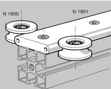
Les guidages linéaires NAP sont constitués d'un rail en alliage d'aluminium anodisé et d'un chariot à deux ou quatre galets. D'un fonctionnement doux et silencieux, les galets peuvent être montés sur les platines ou directement sur les profilés NORCAN.
