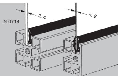
**Ruban de montage - N 0714** pour l'immobilisation de plaques et vitres de 2 à 4 mm dans la rainure. (Pour des plaques en-dessous de 2 mm utiliser 2 rubans!).
