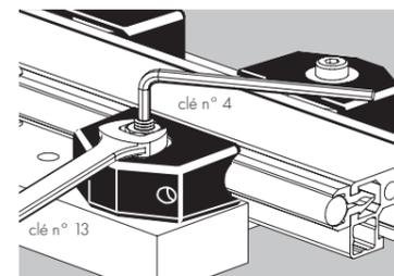
**Montage:** monter d'abord les cassettes à axe excentrique - visser cet axe à fond en tenant l'écrou avec une clé n°13. Par la suite dévisser l'axe d'environ un demi-tour en position "jeu maxi". Serrer très légèrement l'écrou. Monter et serrer les galets à axe cylindrique.
