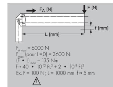
**Charge limites sur le bloc 3 directions**: naturellement, les montages avec le bloc 3 directions ne peuvent pas atteindre les mêmes qualités mécaniques que les montages avec vis centrale M8 x 43 ou M8 x 20 (cf p 80). En cas de présence de couples importants on veillera donc à renforcer les structures (fig. 3) ou, alternativement, préférer des solutions selon fig. 5 et 6.
