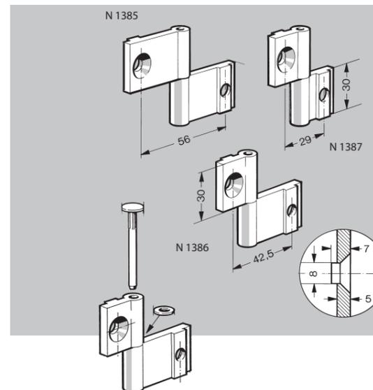
**Charnières aveugles en éléments** avec 2 vis à tête fraisée M8 x 16 et 2 écrous M8 SC. Constituées de deux éléments en aluminium étiré anodisé nature et d'un axe en acier zingué. Il est donc possible de monter des charnières gauches et droites, l'immobilisation de l'axe se fait lors du montage.
