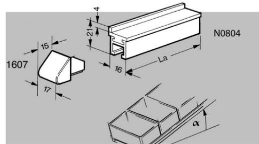
**Rail d'aménagement - N 0804 et N 0805:** pour l'aménagement gravitaire des pièces, petits bacs, platines etc. aux postes de travail.
