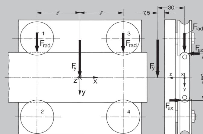
**Exemple 2:** sur le chariot ci-contre agit une charge statique  $F_y = 240$  N sur un point situé 7,5 mm au dessus du centre du chariot,  $v = 2$  m/s.
