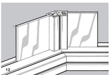
**Montages ajustables:** Les montages avec vis centrale ne permettent qu'un ajustage limité. Pour des réglages plus importants nous recommandons:
