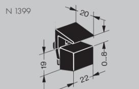
**Bloc fixe panneau 1/4 de tour par clip - N 1399 :** pour la fixation de panneaux de 1 à 8 mm sur la face rainurée des profilés. Le montage s'effectue sans outil. Le démontage exige l'emploi d'un petit tournevis ou autre objet pointu.
