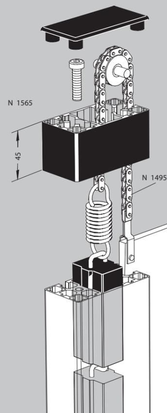
**Boîte à roulette pour chaîne - N 1565** pour panneaux coulissants verticaux. Constituée d'un tronçon de profilé NORCAN 45x90 fermé anodisé noir muni d'une poulie, d'un cavalier inox pour la fixation de panneaux en PC ou stratifié intégral de 8 mm ou de patins en PE N 1347 (voir ci-dessous) et d'un ressort. Important: prévoir 2 N 1565 par porte!
