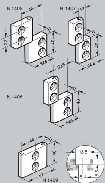
**Charnières en éléments** avec 4 vis M8x20 et 4 écrous M8 SC; Constituées de deux éléments en aluminium étiré anodisé nature et d'un axe en acier galvanisé. Il est donc possible de monter des charnières gauches et droites, l'immobilisation de l'axe se fait lors du montage.
