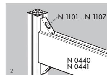
Le montage sur la face de coupe des profils N0440 et N0441 se fait avec les noix d'assemblage N1140 ou les équerres N1101...N1107.
