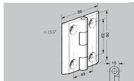
**Charnière 90/49 - N 1507:** avec 4 vis à tête fraisée M8 x 20 zinguées et 4 écrous M8SC. Ouverture maxi 180°.
