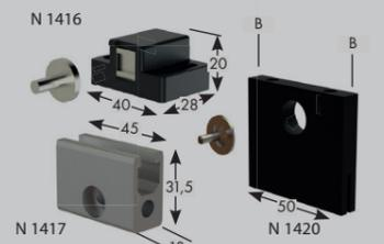
**Aimant double - N 1416:** avec 2 vis M6x25 et 2 écrous M6 SC. Réceptacle à vis M5 avec écrou M5 SC. Force de maintien 10N et 20N. Matière: polyamide noir.
