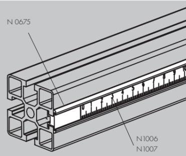
**Profilé support mètre ruban - N 0675 :** permet le montage du mètre ruban N1006 ou N1007 sur un profilé rainuré. Idéal pour le positionnement d'une butée réglable.
