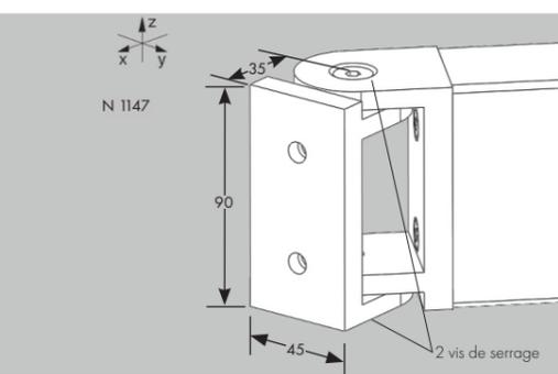
**Articulation 45 x 90 - N 1147** avec 4 vis M8 x 20 et 4 écrous M8 SC pour la fixation sur la face de coupe ou la face latérale des profilés NORCAN.
