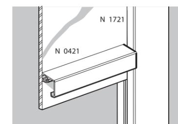
Des panneaux coulissants larges peuvent être renforcés avec le profilé poignée N 0421 (embouts N 1721) pour éviter un fléchissement trop important.
