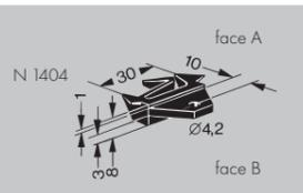
**Patte de fixation - N 1404** avec vis à bois 4 x 20. Pour la fixation de panneaux de 19...22mm, encastrés dans la structure, par vis à bois ou autres. Charge statique maxi par patte : 0,5kN pour panneaux bois ou mélaminés; 1kN pour panneaux alu.
