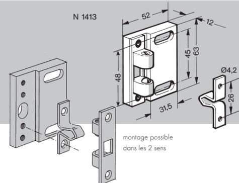
**Arrêt de porte avec loquet à billes N 1413:** avec 2 vis M8x20 et 2 écrous M8 SC - pour des portes d'une épaisseur de 31,5 (18) mm dans des cadres d'une épaisseur de 45 (31,5) mm.
