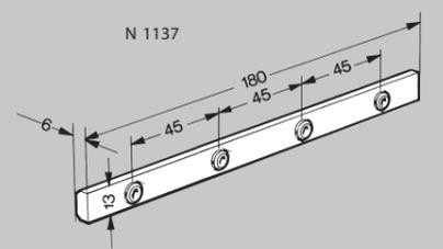
**Barrette de raccordement - N 1137** avec 4 vis sans tête pour le raccordement axial de profilés en présence de faibles charges.
