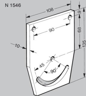
**Platine orientable alu - N 1546** avec vis M8 x 25, rondelles Ø8 - écrous M8 SC écrou double M8 DSC et vis Hc M8x12. Pour le montage inclinable de parties de structure, d'accessoires, convoyeurs etc, écrou double M8 DSC et vis Hc M8x12.
