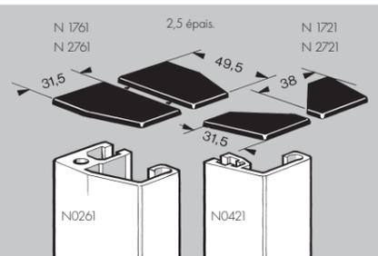
**Profilé 18 x 31,5 poignée - N 0261:** permet d'incorporer la poignée dans la structure des portes de cartérisation. Matière: alliage d'aluminium étiré anodisé nature. Longueur: 6 m ou coupé sur plan.
