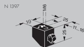
**Bloc de fixation 1/4 de tour par vis - N 1397 :** pour la fixation de panneaux de 1 à 10 mm sur la face rainurée des profilés N 0165, N 0265, N 0275, N 0166,... Le bloc est équipé d'un écrou prisonnier M6 et livré avec une rondelle imperdable M6
