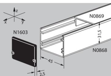
**Profilé en U 31,5x45 - N 0868:** profilé léger pour boîtes à galets - A visser ou à coller avec du ruban adhésif double face sur des structures NORCAN. Matière: aluminium anodisé nature. I<sub>y</sub> = 2 · 10<sup>4</sup> mm<sup>4</sup>
