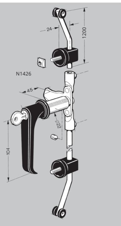
**Fermeture à 3 points avec serrure bec de canne - N 1426 :** Ø22 mm, pour portes en profilés d'une épaisseur de 18 ; 31,5 ; 45 mm. Les tringles d'une longueur de 1200 mm sont à couper à la longueur souhaitée. La clé peut être retirée indépendamment de toutes les positions de la serrure.
