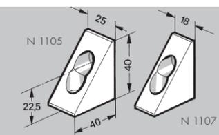
**Equerre 40 x 25 - N 1105** avec 2 vis M8 x 20 CHc et 2 écrous M8 SC
