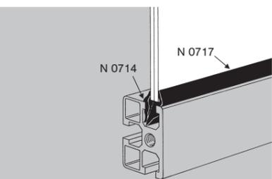
**Joint de montage - N 0717** permet le montage et le démontage de panneaux et de vitres en verre minéral et organique de 5 à 8 mm dans des cadres existants sans démontage préalable de ceux-ci.
