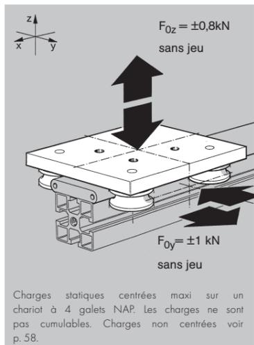
**Guidage linéaire sur galets en polyester NAP 57** (p. 58) : guidage sans jeu au fonctionnement doux et silencieux sur rails en aluminium anodisé.
