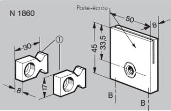
**Kit 1 pour démontage rapide des panneaux - N 1860:** avec visserie. Pour des ouvertures d'accès sur les cartérisations. Le panneau peut être monté et démonté à l'aide d'une seule vis M8 imperdable. Afin d'empêcher leur rotation, les pièces "1" d'appui pour les vis doivent obligatoirement reposer sur une traverse, charnière ou similaire.
