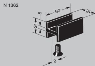
**Profil de guidage en H - N 1362**: avec 1 vis M8 x 10 F et 1 écrou M8 SC. Pour la réalisation de portes coulissantes doubles en profilé 18 x 31,5 mm sur une face rainurée de 45 mm d'un profilé NORCAN. Se prête également à d'autres types de glissières.
