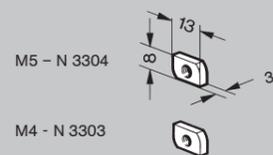
**Écrou quart de tour** pour la fixation rapide en rainure de pièces légères sans exigences de sécurité. Pour les montages courants, utiliser les écrous M5 SC et M4 SC.
