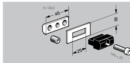
**Patin pour guidage linéaire PE - N 1363** : permet de réaliser des chariots robustes et particulièrement résistants aux charges statiques élevées et aux chocs. Idéal pour l'entraînement par vis trapézoïdale, pour des guidages sans jeu préférer les types NAP 57 (p. 58), K12 (p. 60) et à recirculation de billes (p. 63).
