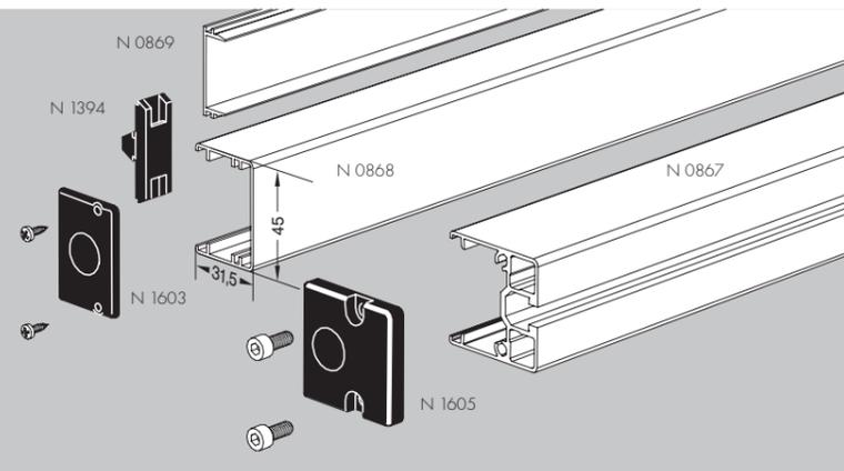
**Profilé en U 31,5 x 45 - N 0868 :** pour une finition soignée des installations de conduits d'air comprimé, câbles, etc. se clipse sur les supports de profilé en U 1/4 de tour N 1394 ou sur le couvercle de goutte N 0869.
