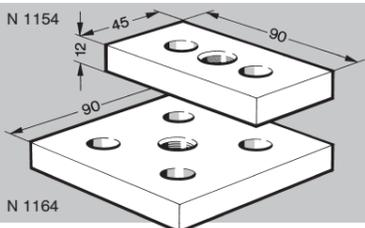
**Embases:** pour le montage des pieds et roulettes avec tige M16 ou M20 (autres taraudages sur demande). Livré avec 2 voire 4 vis M8 x 20 et ses écrous M8 SC. Matière: aluminium anodisé nature.
