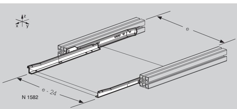
**Paire de glissières**: installation d'une tablette coulissante pour clavier sur poste de travail. Livré avec vis FHc M4x12 et écrous M4 RSC.
