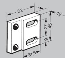
**Arrêt de porte avec butées caoutchouc - N 1474:** avec 2 vis M8x20 et 2 écrous M8 SC - pour tout type de porte dont la face intérieure se trouve à fleur avec la structure du cadre.
