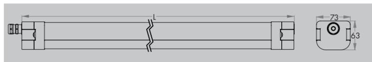
**ManuLED : luminaire à LEDs**
