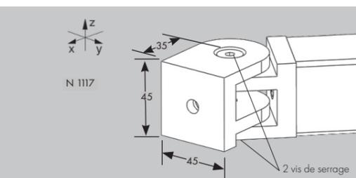
**Articulation 45 x 45 - N 1117** avec 2 vis M8 x 20 et 2 écrous M8 SC pour la fixation sur la face de coupe ou la face latérale des profilés NORCAN. Permet de réaliser des liaisons d'angle fixe de +90° à -90°.
