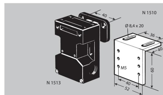
**Contact de sécurité Schmersal AZ 16 - 12 ZVRK - 30N - N 1513** avec visserie (clé rentrée = 1 contact ouvert, 2 contacts fermés, la clé est retenue avec une force de 30N).
