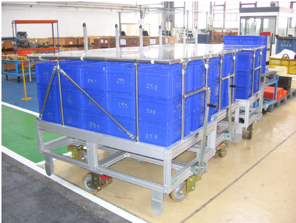
Chariots de manutention type petit train, charge 700 kg Industrial trolleys, trolleys can be connected together, load 700kg per truck Flurförderzeug Typ kleiner Zugwagen, Tragfähigkeit 700 kg
