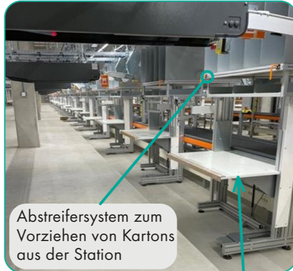
Höhenverstellbare Arbeitsplatte (durch einen Gaszylinder mit Führung): ermöglicht die Anpassung der Tischhöhe an die Höhe der Boxen durch einfachen Druck mit der Hand auf den Tisch
