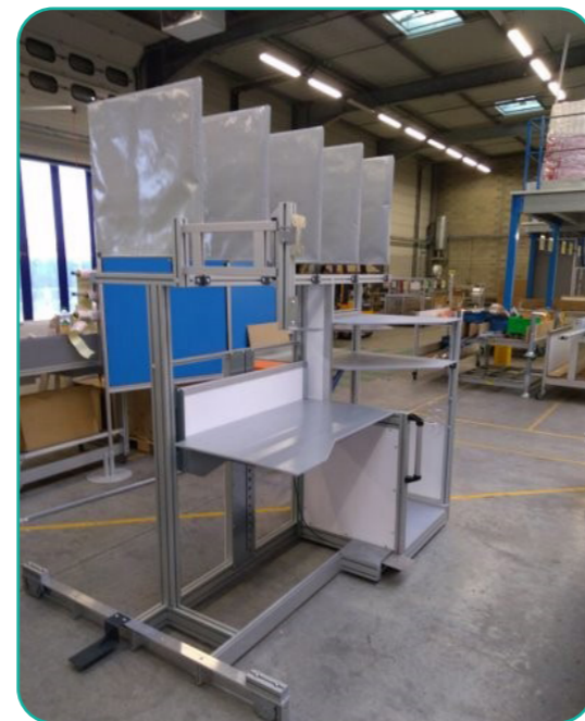
4 hydraulische Teleskopbeine mit Handantrieb und einer Pumpe
