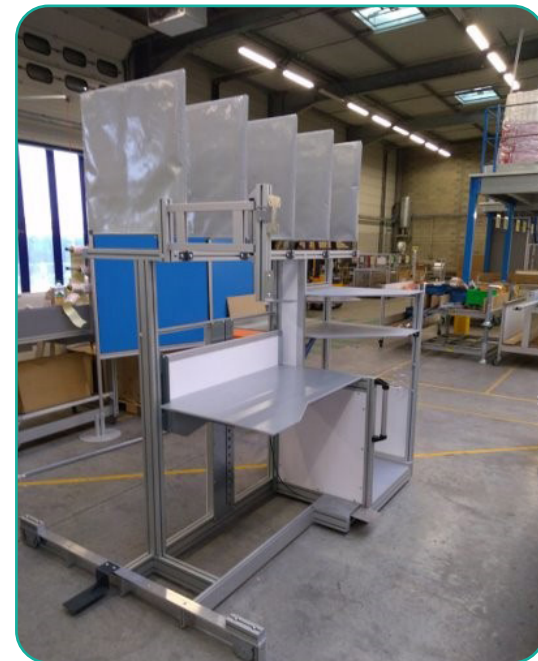
4 pieds hydrauliques télescopiques avec commande manuelle
