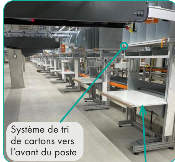
Plan de travail réglable qui permet d'adapter la hauteur de la table par une simple poussée de la main sur la table
