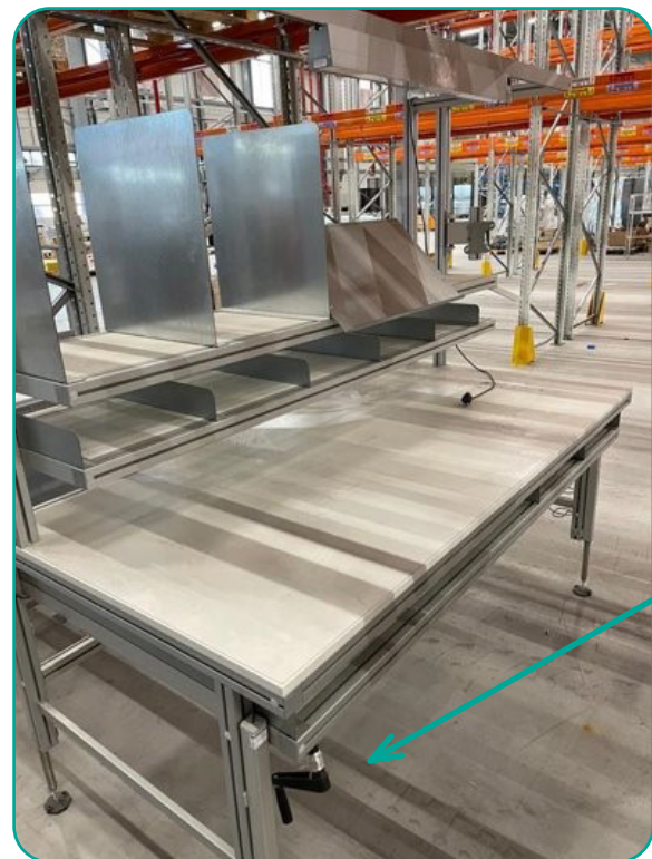
4 pieds hydrauliques télescopiques avec commande manuelle
