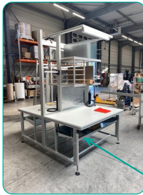
Estante montado en un resorte para garantizar un nivel constante en el transportador de la estación receptora
