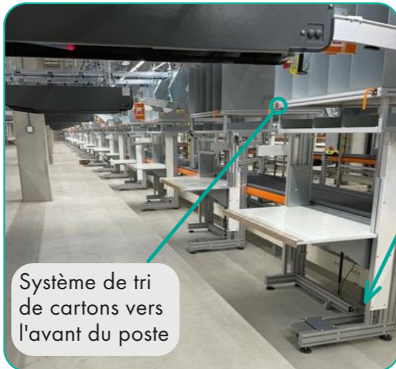
Plan de travail réglable qui permet d'adapter la hauteur de la table par une simple poussée de la main sur la table
