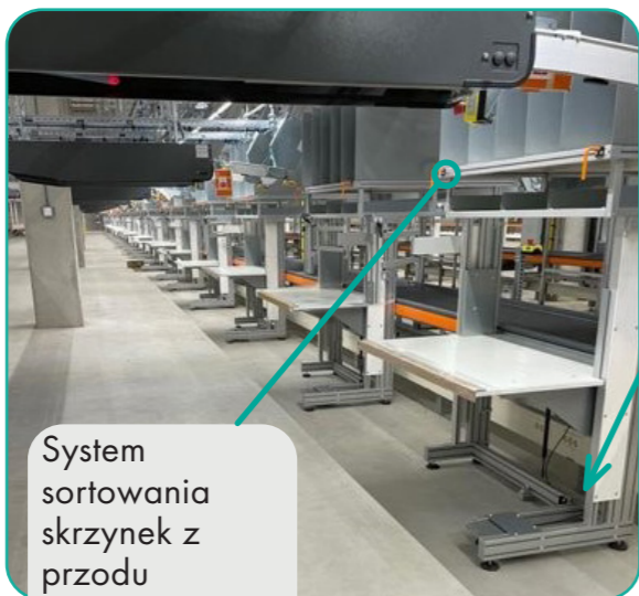
Regulowana powierzchnia robocza, która pozwala dostosować wysokość stołu poprzez proste naciśnięcie ręką na stół
